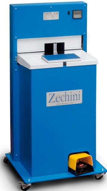
CIMATIC je poloautomatický pneumatický stroj ovládaný pedálem pro lisování a vypalování drážek hřbetu knihy. Stroj je vybaven dvěma noži, jedním pevným druhým pohyblivým pomocí pneumatického válce. Nahřívání nožů je řízeno termostatem. Stroj je vybaven provozním pedálem a je usazen na kolech pro snadnou manipulaci, úsporu místa variabilní nasazení v provozu.
