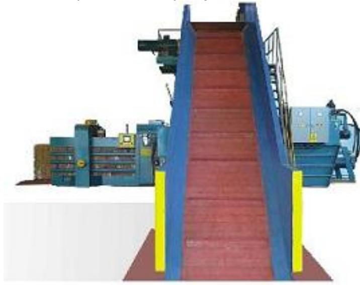
automaticky rozjede a po vysypání do výsypky se opět zastaví. Senzorem je též vybavena výsypka materiálu na lisu. ten hlídá ucpání výsypky na lisem. V případě ucpání výsypky nad lisem je akustickým signálem přivolána obsluha. Další senzor ve výsypce materiálu na lisu je v horní části . Hlídá naplnění výsypky. V případě jeho aktivace je vypnut dopravník. Jeho opětovné zapnutí je možné až v momentě odblokování tohoto senzoru.
